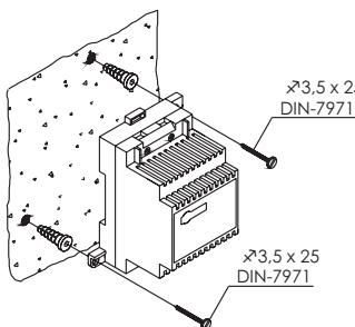
En guía DIN / Sur rail DIN / On DIN guide
