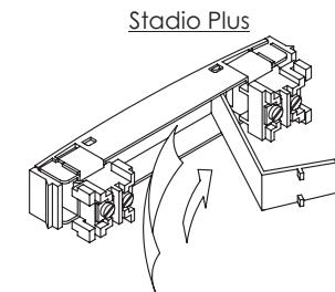
Colocación de las etiquetas de pulsadores y ajustes del nivel de audio.
